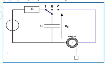
On charge le condensateur par un générateur de tension continue (K en position 1) et on bascule l'interrupteur K en position 2;
