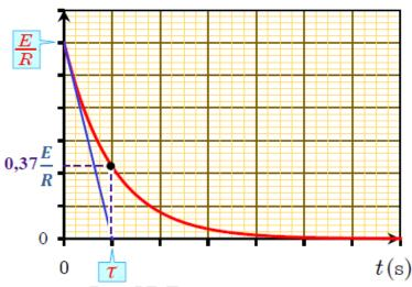
b- Réponse d'un dipôle RC à un échelon de tension descendant (décharge de condensateur):
