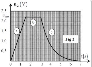
A l'aide d'un dispositif d'acquisition, il visualise l'évolution de la tension  $\mathfrak{u}_{c}$  aux bornes du condensateur. Il obtient la courbe représentée dans la figure 4.
