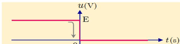
Cela est réalisé en basculant l'interrupteur  $K$  (dans le circuit ci-dessous) de la position 1 (charge de condensateur) à la position 2 (décharge de condensateur) à un instant considéré comme origine de temps ( $t = 0$ ):
