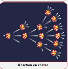
Dans les centrales nucléaires, la réaction en chaine est contrôlée pour produire une quantité d'énergie souhaitée.
