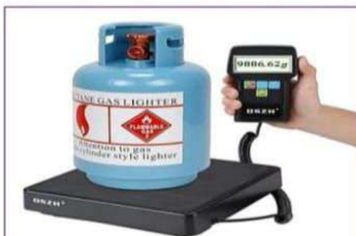
Figure 1 : La masse de la bouteille contenant le gaz m = 9886,62\text{g}
