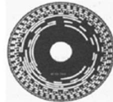
**Q.22.** Confirmation ou négation quant au pouvoir du codeur de résolution **R = 500 impulsions/tour** à mesurer la position de la table avec la précision de 0,01 mm.
